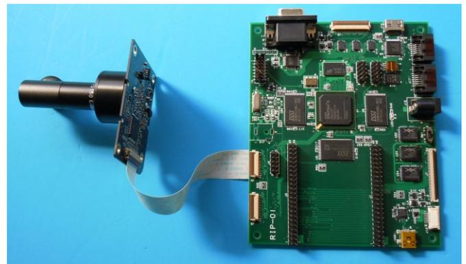
テレセントリック・レンズ+カメラ+FPGA 画像処理基板
