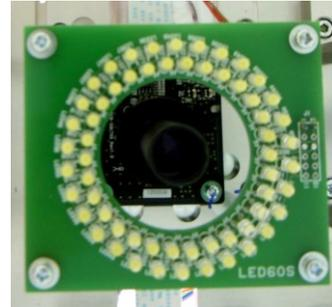
反射型LED照明基板
